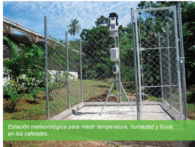
Estación meteorológica para medir temperatura, humedad y lluvia en los cafetales.
