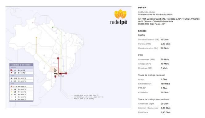
Em termos gerais, a Rede Ipê está construída em cima de um emaranhado de conexões de fibraóptica pelo país e junto a ANSP a conexão é de 1Gb/s. O INPE está conectado a ANSP também a 1Gb/s. A conexão do IAI ao INPE ocorre através de um par de fibra-óptica a 100Mb/s. Todos os nossos computadores trabalham nessa banda.
