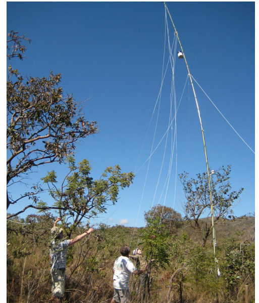
Instalación de una estación de monitoreo de la fenología, Minas Gerais, Brasil
