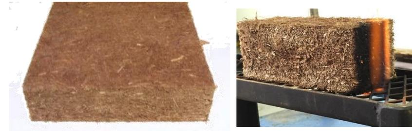
Paneles aislantes de corteza de eucalipto
